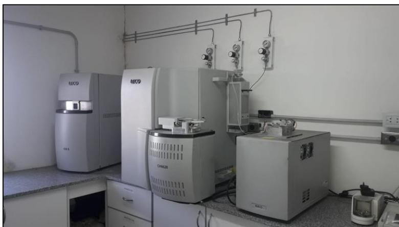
**Figura 39:** Equipo de composición elemental marca LECO modelo CHNOS628.
