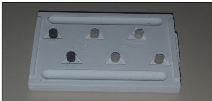
**Figura 46:** Muestras de cenizas para análisis de fusibilidad del CETER.
