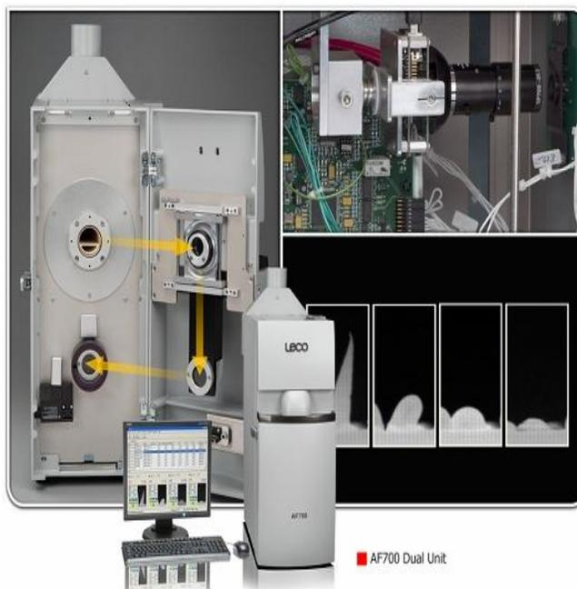
**Figura 47:** Equipo de fusibilidad de cenizas de la Universidad de ciencias Aplicadas de Mittelhessen.
