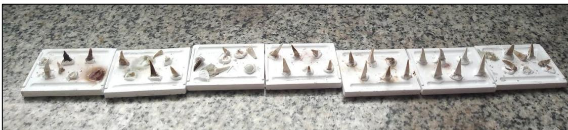
**Figura 41:** Conos de cenizas que se expusieron a la atmosfera oxidativa, análisis de fusibilidad.
