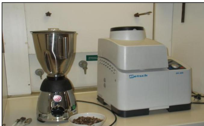
**Figura 45:** Molino de ultracentrifugación empleado para reducir el tamaño de las muestras.
