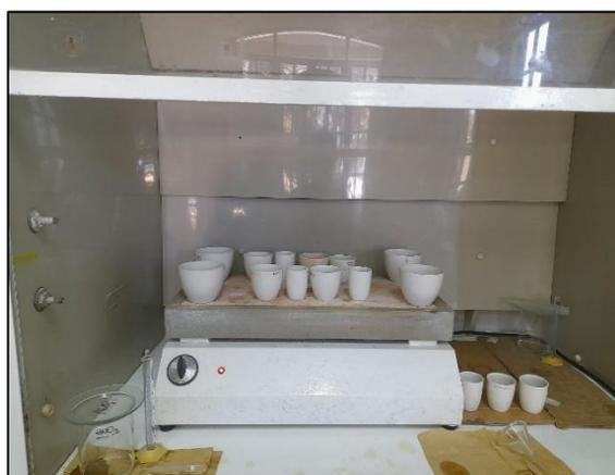
**Figura 43:** Digestión ácida de muestras de cenizas en el análisis de metales.
